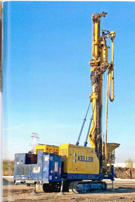
werden konnten, wurden mit einem Klemm Bohrgerät Sondierungen durchgeführt und eventuell vorhandene Hohlräume mit einer Suspension verfüllt. Die Basis für diese Sondierungsbohrungen erhielt Bauleiterin Melanie Neumar, Keller Grundbau Ges.mbH, durch das System Vibro Scan der Firma Keller. Es ermöglicht die grafisch übersichtliche Darstellung der Ergebnisse des Tiefenschreibers.
